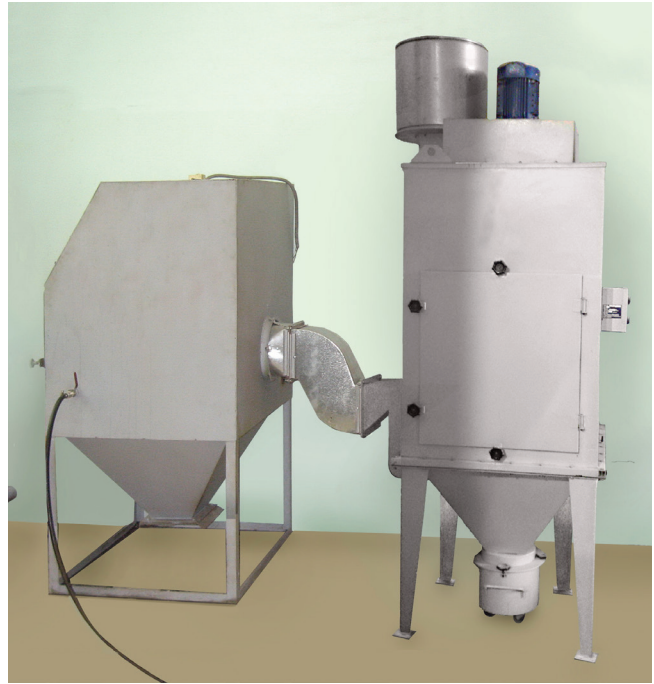
АОУМ-2000-ПС Участок пескоструйной обработки
