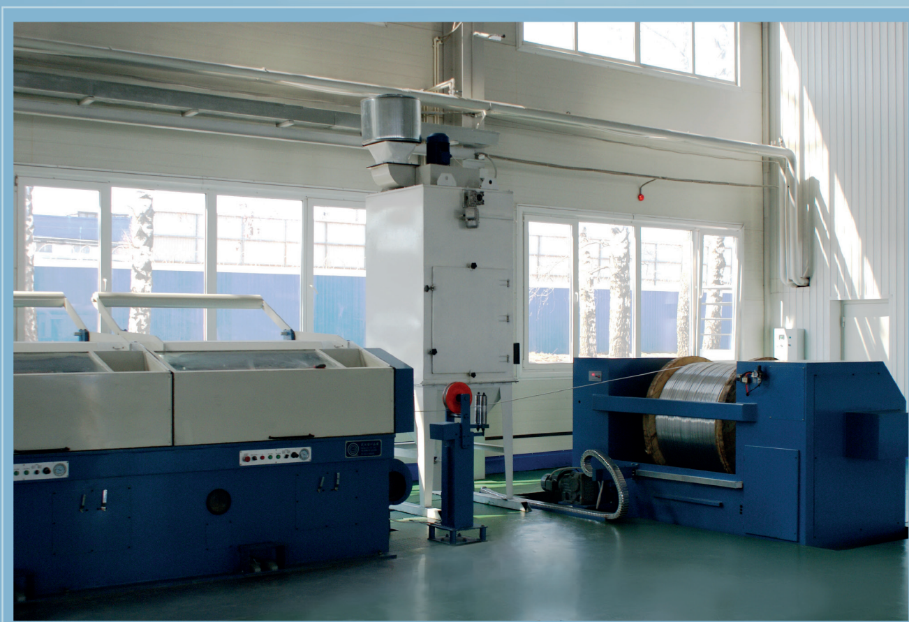
АОУМ-4000 Производство оптического волокна
